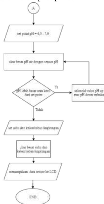
Gambar 9. Flowchart Perangkat Lunak
